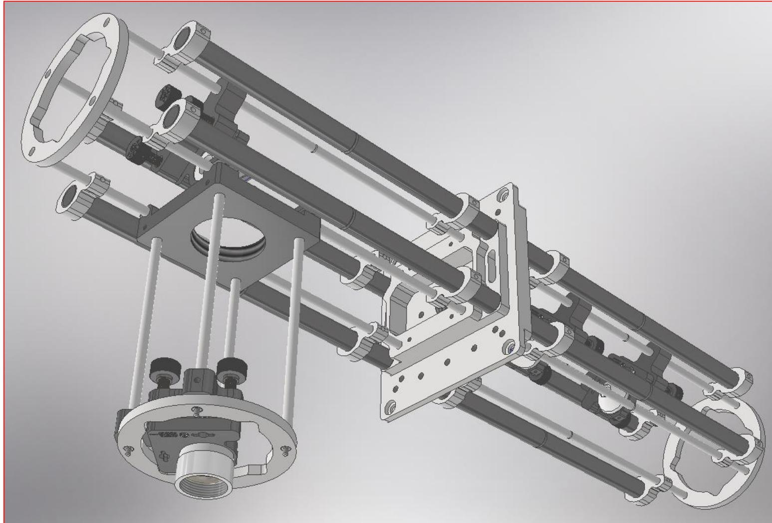
**Короткофокусный модуль** позволяет использовать порталную платформу с различными видами короткофокусных объективов. Узел оснащается диодным лазером позиционирования заготовки под объективом.
